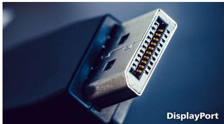
DisplayPort 是一种数字链接, 可从 PC 到显示器实现双向连接, 而无需任何转换。借助比 DVI 标准更强大的功能, 其完全支持 15 米长线缆和 10.8 Gbps/ 秒的数据传输。凭借其高性能和零滞后时间, 您可获得最
