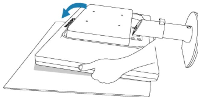
2) Entfernen Sie die 4 Schrauben und dann den Fuß von dem LCD-Monitor.
