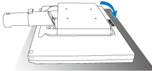
2) Schieben Sie den Basisstander kraftig auf die Säule, bis die Nasen einrasten; die höhenverstellbare Säule wird freigegeben. Hinweis: Bei richtiger Anbringung fährt der höhenverstellbare Hals sofort aus. Note: When properly installed, the height adjustable neck will immediately extend .
