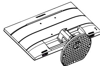
2. Нажмите фиксаторы, чтобы отсоединить подставку монитора от основания.
