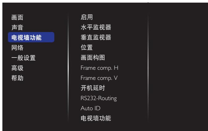
利用此功能, 可以组成一个最多包括 100 台此显示器的大屏幕矩阵 (视频墙) (纵向每排最多 10 台, 横向每排最多 10 台)。
