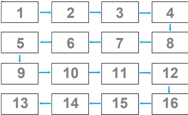
注意：为了使用此功能，应利用 RS-232 线串联所有机器，并将它们的网络控制端口设为 RS-232。
