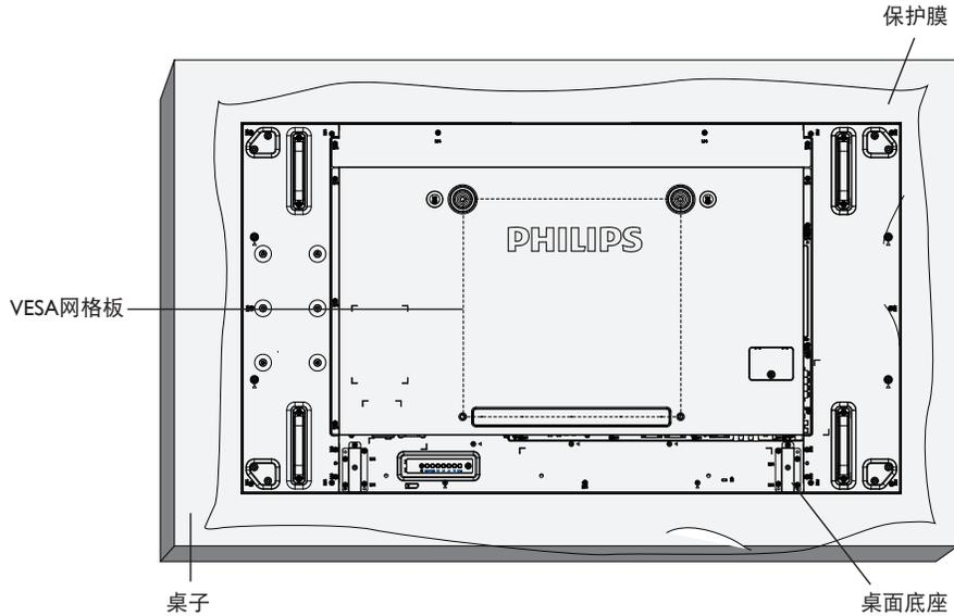
1. 将保护膜（打包时包裹在显示器上）铺在桌子上，将显示器正面朝下放在保护膜上，以免刮擦屏幕表面。
