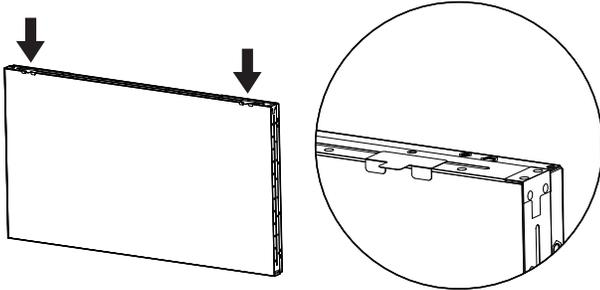
3. Installieren Sie das obere Display vorsichtig. Achten Sie nach Montage der Displays darauf, genügend Platz zwischen den Displays zu lassen, damit sich das Abstandspolster entfernen lässt. Falls sich das Polster nur schwer lösen lässt, passen Sie die Position des Displays so an, dass genügend Platz vorhanden ist.
