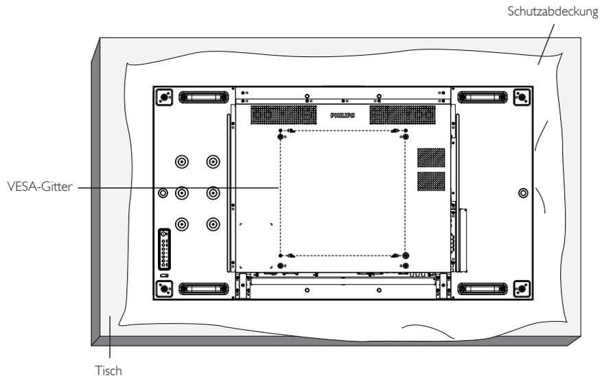
1. Breiten Sie die um das Anzeigergerät gewickelte Folie zum Schutz auf einem flachen Untergrund aus. Legen Sie das Anzeigergerät mit der Bildschirmseite nach unten auf die Folie, damit der Bildschirm nicht verkratzt.
