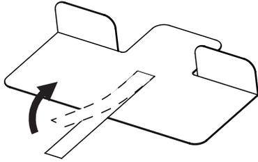
2. Kleben Sie das Abstandspolster auf die Oberfläche des Displays, an der ein anderes Display eingerichtet werden soll. Bringen Sie 2 Abstandspolster an der Oberfläche an.
