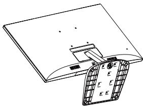
2. Відкрутіть гвинт унизу основи за допомогою пальців і від'єднайте основу від підставки.
