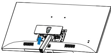
4. Відкрутіть гвинти з тримача за допомогою викрутки та від'єднайте тримач/підставку від монітора.
