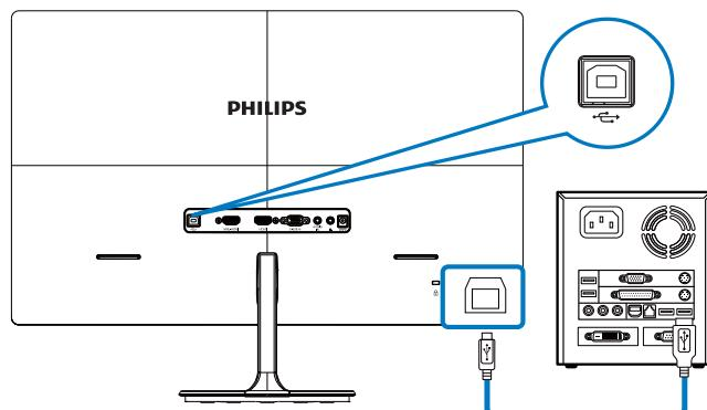
1. 将USB线从PC一端连接到显示器侧面IO上USB集线器的上行端口。
