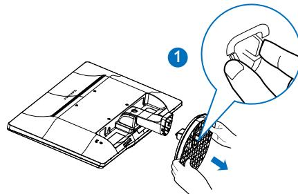
3. Trykk på utløserknappen for å løsne skjermøylen.
