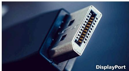
DisplayPort je digitalna veza između računara i monitora, bez konverzije. Uz veće mogućnosti u odnosu na DVI standard, u potpunosti podržava kablove dužine do 15 metara i brzinu prenosa podataka od 10,8 Gb/s. Zahvaljujući visokim performansama i malom kašnjenju, dobijate
