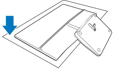
2. 用双手拿住显示器和底座。轻轻地垂直向下扳动底座至固定角度。
