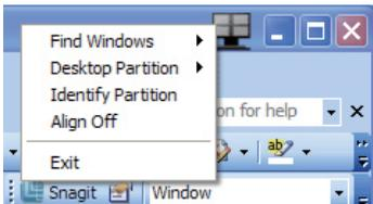
1. **Find Windows（查找窗口）** – 在某些情况下，用户可能将多个窗口发送到了同一个分区。Find Window（查找窗口）将显示所有打开的窗口，并将所选的窗口移动到最前面。
