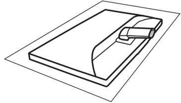
2. Tenez le support du socle du moniteur avec deux mains et insérez fermement le support du socle dans la colonne du socle.
