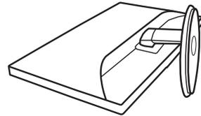
2. Appuyez sur les clips de verrouillage pour détacher le support de la colonne du socle.
