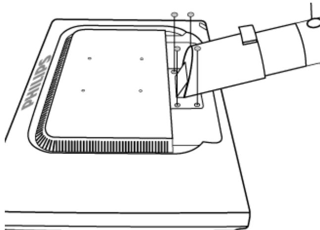
Die 4 Schrauben herausdrehen und dann den Fuß vom LCD-Monitor abnehmen
