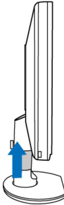
(b) Legen Sie den Monitor mit der Anzeigefläche nach unten auf eine flache Unterlage; achten Sie dabei darauf, den Bildschirm nicht zu verkratzen oder anderweitig zu beschädigen. Heben Sie dann den Monitorständer an.
