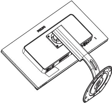
2. Afloje los tornillos de ensamblaje y, a continuación, desmonte el cuello del monitor.
