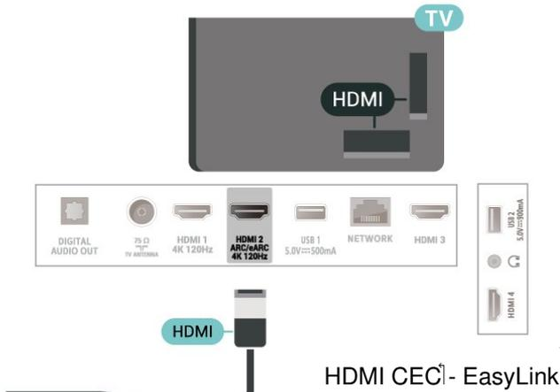
عند توصيل الأجهزة المتوافقة مع HDMI CEC بالتلفزيون الخاص بك، يهكك تشغيلها باستخدام جهاز التحكم عن بُعد في التلفزيون. يجب تشغيل HDMI CEC EasyLink على التلفزيون والجهاز المتصل.
