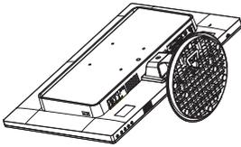
2. Appuyez sur les clips de verrouillage pour détacher le support de la colonne du socle.
