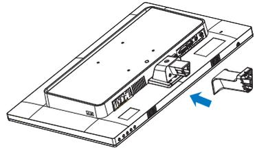
3. Tenez le support du socle du moniteur avec deux mains et insérez fermement le support du socle dans la colonne du socle.
