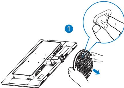
3. Appuyez sur le bouton de détachement pour détacher la colonne de base.
