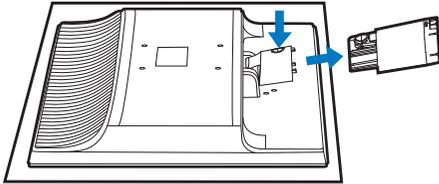
2. Entfernen Sie die 2 Schrauben und nehmen Sie dann den Standfuß vom Monitor ab.
