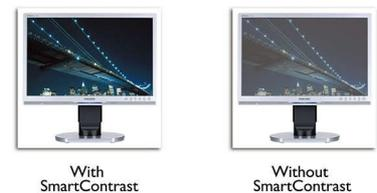
SmartContrast là công nghệ của Philips phân tích nội dung bạn đang hiển thị, tự động điều chỉnh màu và điều khiển cường độ ánh sáng nền để có được video và hình ảnh số tốt nhất, hoặc khi chơi trò chơi hiển thị những màu tối màu. Khi chế độ Tiết kiệm được chọn, độ phân giải được điều chỉnh và ánh sáng nền được tinh chỉnh để hiển thị vừa phải cho những ứng dụng văn phòng hàng ngày và tiêu thụ năng lượng ít hơn.
