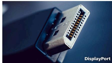
O DisplayPort é uma ligação digital entre o PC e o monitor, sem necessidade de conversões. Com capacidades superiores ao padrão DVI, é
