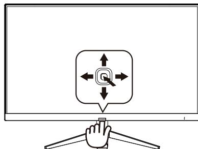
此 Philips 显示器的 OSD 菜单可以通过显示面板下部的单触按钮来访问。单触按钮的操作类似于操纵杆。向四个方向按下按钮可以移动光标。向里按下按钮可以选择所需的选项。
