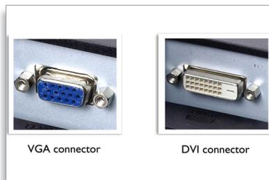
La doble entrada proporciona conectores para entrada de señales VGA analógicas y DVI digitales.
