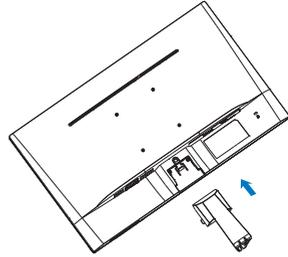
3. 請用雙手緊握顯示器底座支架，並將底座支架確實裝入底座安裝座中。
