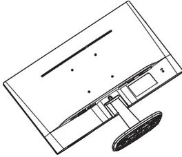
2. 壓下鎖定夾可分離底座支架與底座安裝座。
