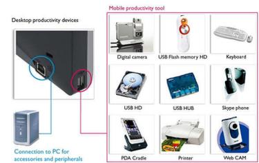
USB 連接埠讓用戶能夠方便地連接他們的即插即用多媒體裝置，例如 USB 記憶裝置、相機、便攜硬碟機、電腦鏡頭、PDA、打印機等其它具有 USB 連接功能的裝置。顯示器上很容易就能找到的 USB 2.0 連接埠讓 USB 2.0 信號能夠傳輸到電腦上。請注意，許多裝置（例如相機及硬碟機）可能需要單獨連接電源，因為它們的電力需求會比顯示器 USB 連接埠所能提供的電力更高。
