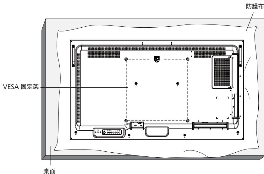
1. 顯示器擺放在平坦表面上時展開包覆顯示器的防護布。讓顯示器正面朝下放置在防護布上，以協助您操作而不會刮傷螢幕。
