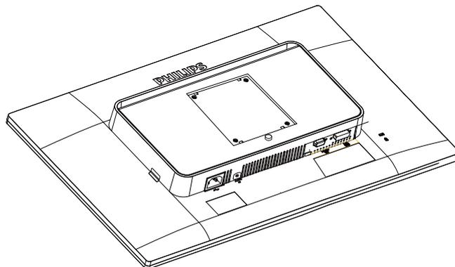
2. Přichyťte podstavec do umístění držáku VESA.
