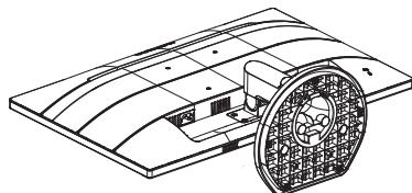
2. Нажмите фиксаторы, чтобы отсоединить подставку монитора от основания.
