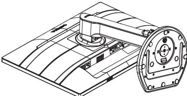
3. Нажав кнопку фиксатора, наклоните основание и извлеките его.
