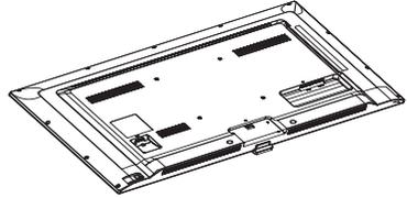
2. 将底座插到支架后，锁紧螺丝。用双手拿住底座，将支架插入后壳上支架槽并锁紧螺丝。
