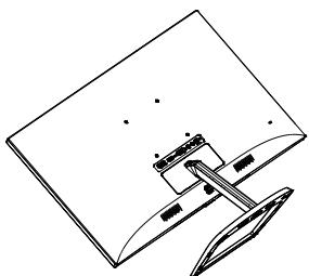
2. Відкрутіть гвинт унизу основи за допомогою пальців і від'єднайте основу від підставки.
