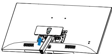
4. Вікрутіть гвинти з тримача за допомогою викрутки та від'єднайте тримач/підставку від монітора.
