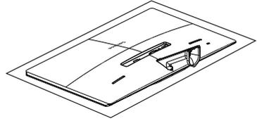
2. Tenez le support du socle avec deux mains et insérez fermement le support du socle dans la colonne du socle.
