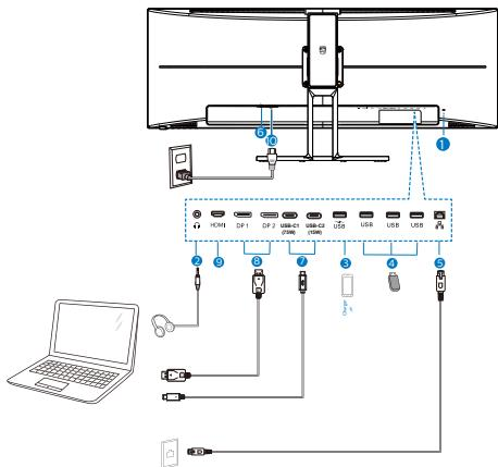
3. 将显示器信号线连接到计算机背面的视频接口。
