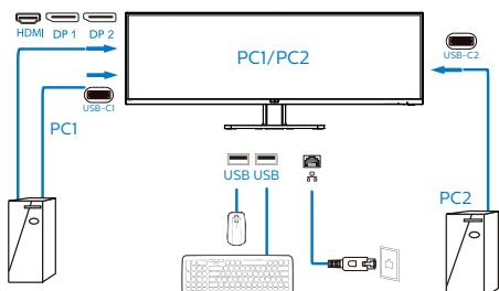
3. 进入OSD菜单。进入KVM层，通过选择“自动”、“USB-C1”或“USB-C2”将外设的控制从一台设备切换到另一台设备。重复此步骤即可通过使用一组外设来切换控制系统。
