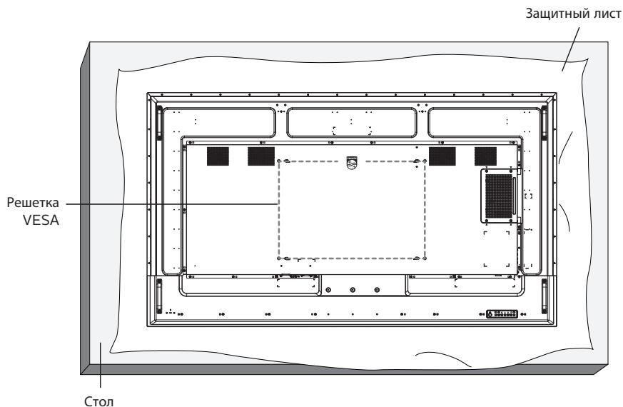
1. Застелите ровную поверхность защитным листом, которым был обернут монитор при упаковке. Положите монитор вниз экраном на защитный лист, чтобы защитить поверхность экрана от царапин в процессе установки.
