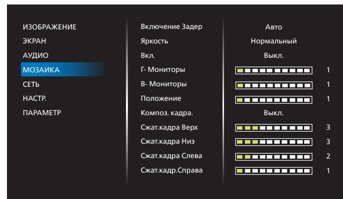
Благодаря данной функции, можно создавать единую широкоэкранную матрицу (видеостену), состоящую из 150 мониторов (до 10 мониторов по вертикали и 15 мониторов по горизонтали). Для выполнения данной функции необходимо соединение "цепочкой".
