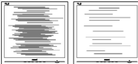
Appuyez sur le bouton Auto. Supprimez les barres verticales à l'aide de More Settings of Phase/Clock (davantage de réglages de phase/horloge) dans les commandes principales OSD.
