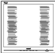
Appuyez sur le bouton Auto. Supprimez les barres verticales à l'aide de More Settings of Phase/Clock (davantage de réglages de phase/horloge) dans les commandes principales OSD.
