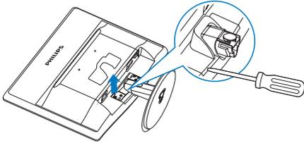
2. Lösen Sie die vier Schrauben, nehmen Sie die Basis anschließend vom Monitor ab.
