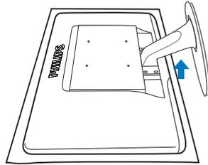
2. Tenez le support de la base du moniteur avec deux mains et insérez fermement le support de la base dans la colonne de la base.
