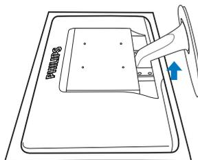
2. Appuyez les clips de verrouillage pour détacher le pied de la base de la colonne de la base.
