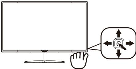
Philips 모니터의 OSD 메뉴에 액세스하면, 간단히 모니터 베젤의 후면에 있는 단일 토글 버튼을 사용하십시오. 단일 버튼은 조이스틱과 같이 작동합니다. 커서를 이동하려면, 간단히 네 방향으로 버튼을 토글하십시오. 버튼을 눌러 원하는 옵션을 선택합니다.
