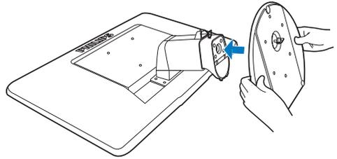
3. Attaccare la base del monitor al supporto, poi fissare la base.
