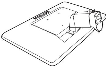
2. Tenere la base del monitor con entrambe le mani ed inserire con fermezza la base nel supporto.
