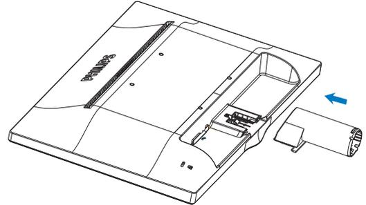
3. Tenez le support du socle du moniteur avec deux mains et insérez fermement le support du socle dans la colonne du socle.
