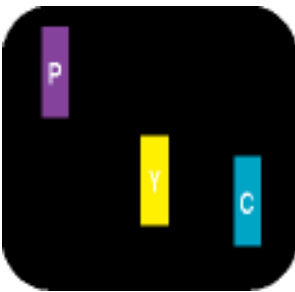
Deux sous-pixels allumés adjacents : - Rouge + Bleu = Violet - Rouge + Vert = Jaune - Vert + Bleu = Cyan (Bleu pâle)
