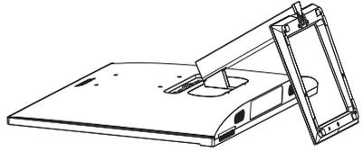
2. 用螺絲刀鬆開底座底部的螺絲，並取出底座中的基座。
