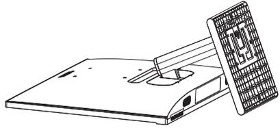
2. (1) 用螺絲刀鬆開底座底部的螺絲。
