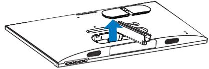
4. 用螺絲起子取下支臂上的螺絲，然後從螢幕拆下支臂／支架。
