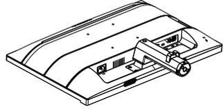
2. (1) Κρατήστε το στήριγμα της βάσης και με τα δύο χέρια και εισαγάγετε σταθερά το στήριγμα της βάσης στη στήλη της βάσης.
