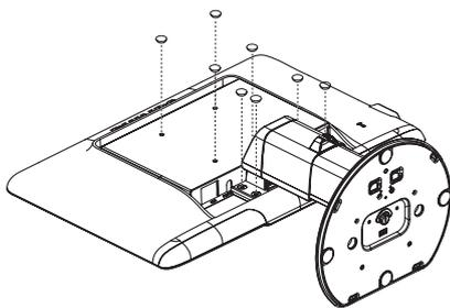
2. Открутите 4 винта и снимите подставку с монитора.
