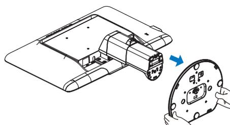
2. Положите монитор экраном вниз на ровную устойчивую поверхность, соблюдайте осторожность, чтобы не поцарапать и не повредить экран. Поднимите подставку монитора.
