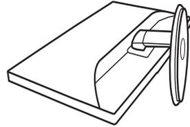
2. Pressione as patilhas de bloqueio para retirar a base da coluna de suporte..
