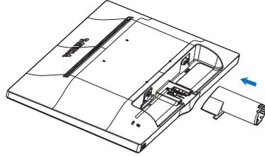
3. 用双手拿住显示器底座支撑臂，用力将底座支撑臂插入底座支撑柱。
