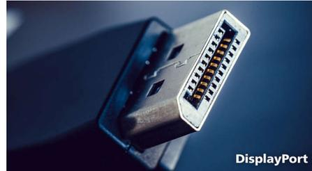
DisplayPort merupakan sambungan digital dari PC ke Monitor tanpa konversi apa pun. Dengan kemampuan yang lebih tinggi dibandingkan standar DVI, sepenuhnya mendukung kabel hingga 15 meter dan transfer data 10,8 Gbps/dtk. Dengan performa tinggi dan latensi nol, Anda mendapatkan tingkat pencitraan dan penyegaran tercepat - menjadikan DisplayPort pilihan terbaik untuk tidak hanya penggunaan di kantor atau di rumah, tetapi juga untuk game
