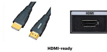
Perangkat HDMI-ready memiliki semua perangkat keras yang diperlukan untuk menerima input High-Definition Multimedia Interface (HDMI). Kabel HDMI memungkinkan video dan audio digital berkualitas tinggi ditransmisikan melalui kabel tunggal dari PC atau sejumlah sumber AV (termasuk set-top box, pemutar DVD, penerima A/V dan kamera video).
