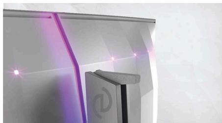
Подсветка Ambiglow — это новые впечатления от просмотра. Инновационная технология Ambiglow улучшает изображение, создавая световой ореол на мониторе. Быстрый процессор анализирует входящий контент и постоянно адаптирует цвет и яркость излучаемого света в соответствии с изображением. Прекрасно дополняет фильмы, спортивные трансляции и игры. Philips Ambiglow — принципиально новый уникальный уровень просмотра и погружения в происходящее на экране.
