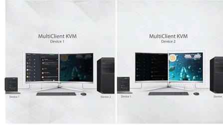
Mit der integrierten KVM-Switch können Sie zwischen zwei Geräten mit einer einzigen Tastatur und Maus steuern und wechseln. Mit MultiView können Sie beide Quellen gleichzeitig auf einem Bildschirm betrachten. Mit diesen Funktionen können Sie Kabelsalat reduzieren und wertvolle Zeit sparen. Perfekt für Streamer mit zwei PCs, Content-Ersteller oder für die Vorbereitung von Geräten auf ein LAN-Ereignis.
