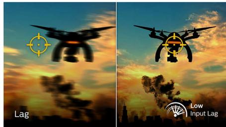
입력 지연이란 연결된 장치로 수행하는 동작과 스크린에서 표시되는 결과 사이에 소요되는 시간을 의미합니다. 입력 시간이 짧으면 장치에서 모니터로 명령을 입력하는
