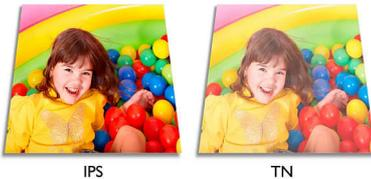
I display IPS utilizzano una tecnologia avanzata che offre un angolo visuale estremamente ampio di 178/178 gradi, rendendo possibile la visualizzazione da qualsiasi angolazione, anche in modalità di rotazione di 90°. A differenza dei pannelli TN standard, i display IPS garantiscono immagini davvero nitide dai colori naturali, così da renderli ideali non solo per foto, film e navigazione in rete, ma anche per quelle applicazioni professionali che richiedono colori accurati e costante luminosità.
