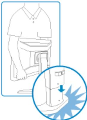
! Без фиксатора основание стойки может выпасть
