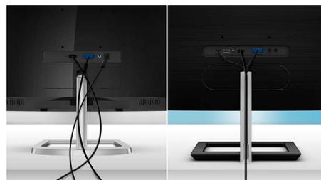
Pour un espace de travail plus net, ce moniteur est doté d'une solution élégante pour la gestion des câbles. Il n'est pas nécessaire de rassembler les câbles avec des attaches supplémentaires. Une fente allongée permet de ranger les câbles en toute discrétion. Elle dissimule les câbles et trouvera sa place dans la plupart des environnements, en particulier pour les petits
